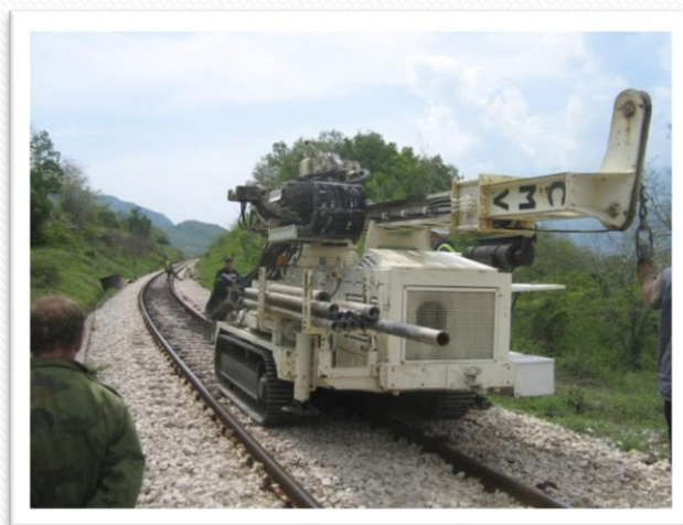
Transport bušaće garniture na lokaciju bušotine P-2
