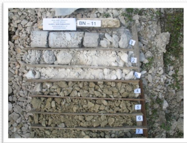
Jezgro bušotine Bn-11 na stacionaži km 22+842 (dubina fundiranja zida na ovoj lokaciji je 1.6 m, od 1.6 do 3 m je blok krečnjaka i od 3 m do 8 m je osnovna stijenska masa - fliš)
